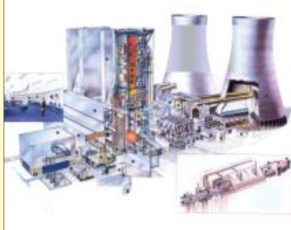
Nad elektrárnu nikdy nevychází žádný komín, kompaktní budova je celá obložená eloxovaným hliníkem se samočisticím účinkem
